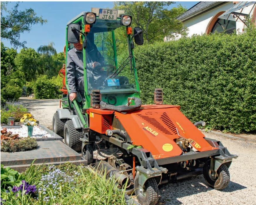
Prototyp des Infrarotgeräts 750 von Adler zur Wildkrautbekämpfung auf einem Nilfisk-Geräteträger
