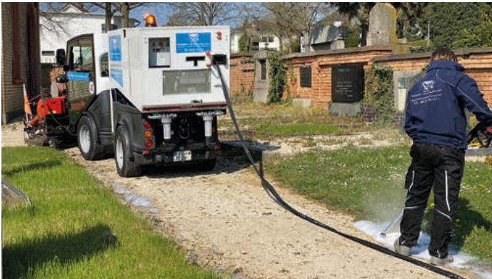
Kombimaschine im Einsatz auf dem Friedhof. Circa 900 °C kommen über den Infrarotvorbau am Boden an. Ein Mitarbeiter geht der langsam fahrenden Arbeitsmaschine hinterher und bearbeitet die starke Verkräutung am Wegrand mit der Heißwasser/Heißschaum-Methode.
